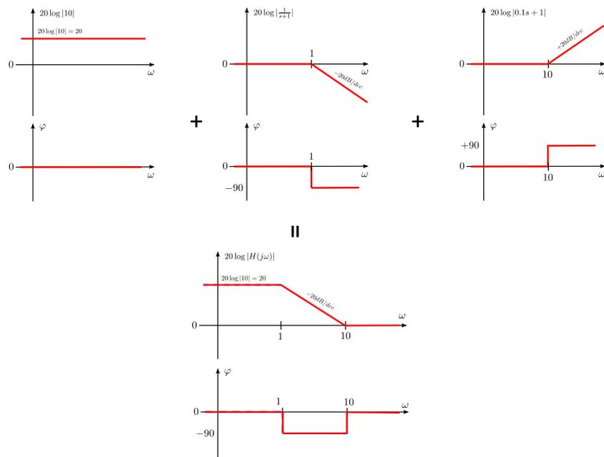
FIGURE 7: Diagramme de Bode de la fonction (3).
