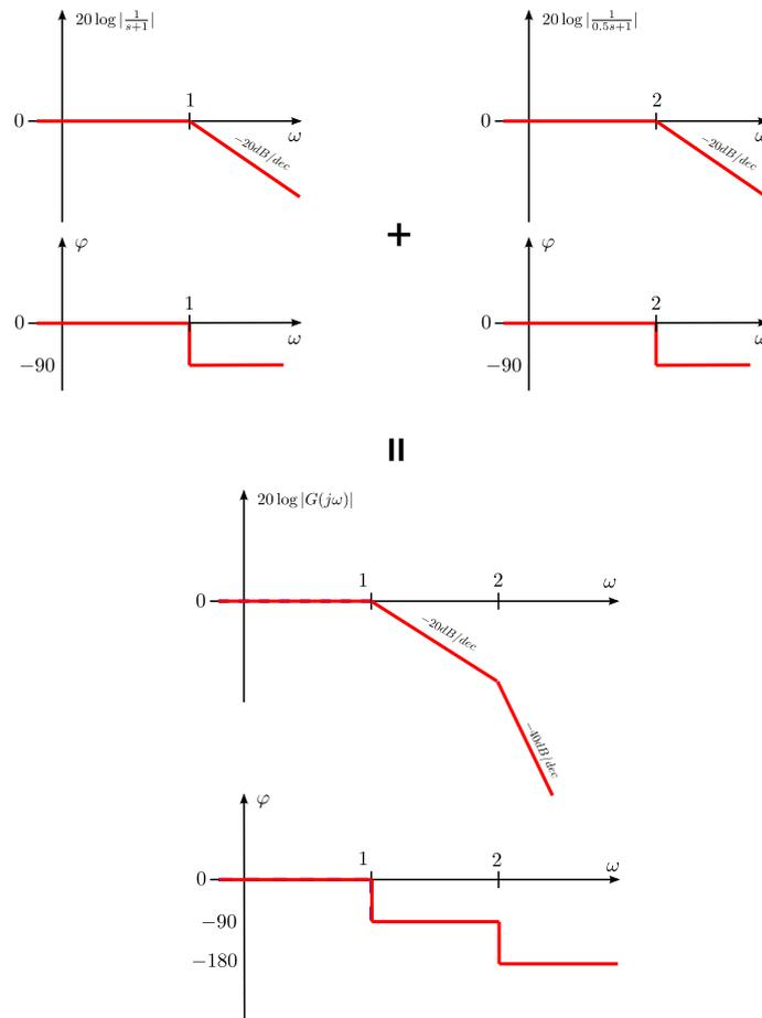
FIGURE 6: Diagramme de Bode de la fonction (2).
