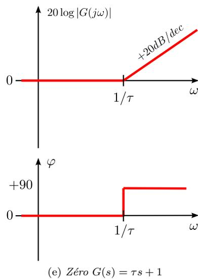
FIGURE 5: Diagrammes de Bode des fonctions élémentaires.
