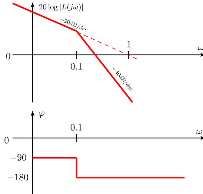
FIGURE 9: Diagramme de Bode de la fonction (5).
