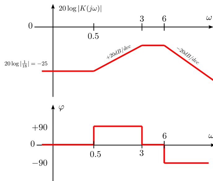
FIGURE 8: Diagramme de Bode de la fonction (4).
